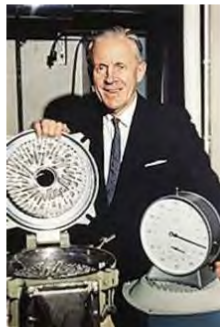
Arne Asplund med sin raffinör för framställning av mekanisk massa från flis. Från början avsedd för massa till fiberskivor utvecklades metoden för tillverkning av mekanisk pappermassa
