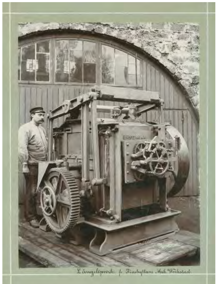
Långslipverk av Albert Bergströms konstruktion och tillverkat vid Finshyttans mekaniska verkstad i Filipstad. Funktionen framgår inte enklert av bilden, men veden lades in så att kubbarna slipades i vedens längsriktning i motsats till det normala i vedens tvärsriktning. (Ur Tekniska museets arkiv, Stockholm)
