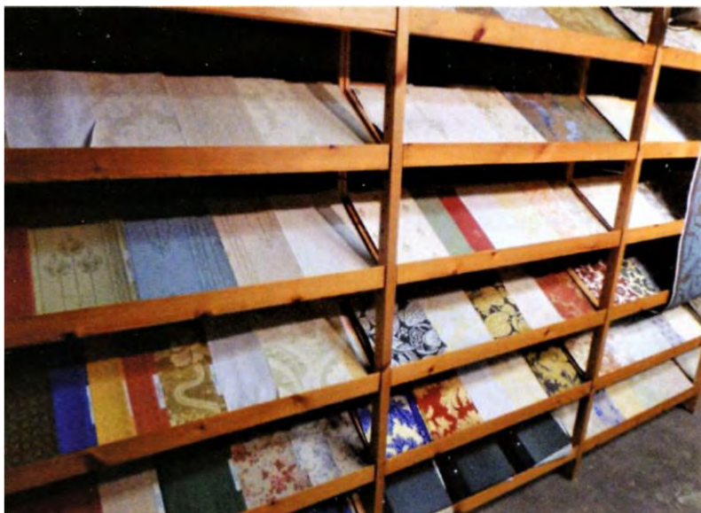
Exempel på tapetmönster och presentationsmaterial hos Lim & Handtryck. Tapeterna trycks med teknik och material av en typ som användes under 1700- och 1800-talen. Utöver maskintryck som beskrivs i texten kan man också göra blocktryck, där tryckformen är en platta och tryckningen helt manuell.
