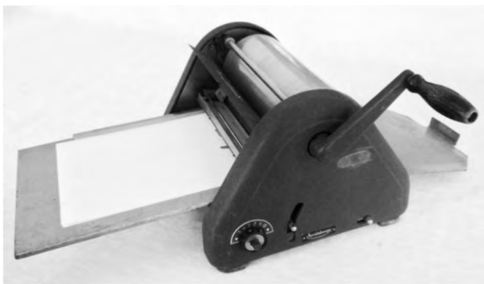
En svensktillverkad spritduplikator av märket "Årvidaberg". Den introducerades 1952 och tillverkades i Lennartsfors i Värmland.
