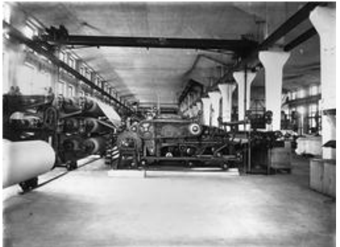
En tidig arkmaskin placerad i byggnadsskeppet för PM2. Senare byggdes pappersbruket till med en avdelning för arkning och annan konvertering. På bilden matas arkmaskinen med papper från åtminstone nio pappersullar.
