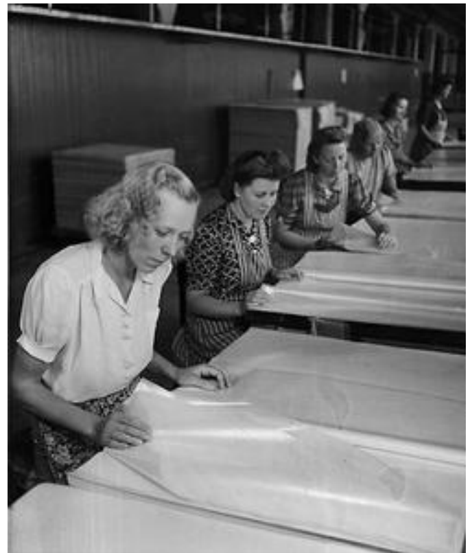
Arksortering innebar både att räkna arken i en bunt och att sortera ut defekta ark. I detta fall hanteras specialpapperet "pergamyn", av glansen på papperet att döma.
