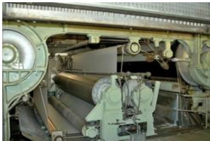
Limpress på PM2. Den används för att ge en ytbeläggning med CMC som gör papperet tätare inför senare beläggning med t.ex. silikon.
