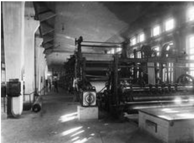
PM1 med rullmaskin. Rullmaskinen har en vacker skylt med texten "H Füllner, Warmbrunn".
