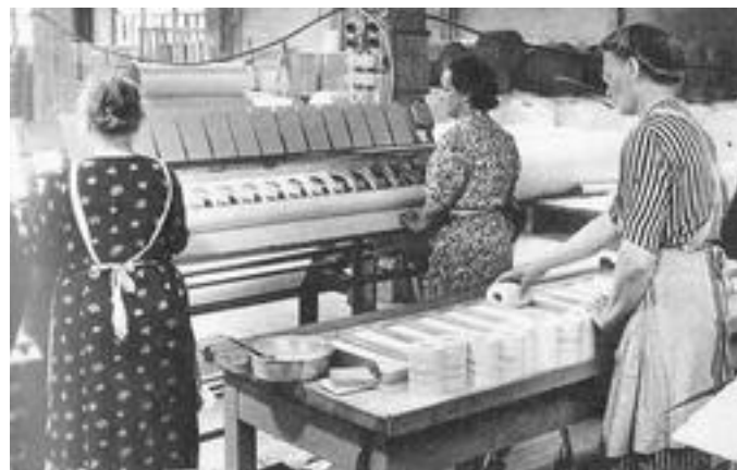
Cellulosaavadd tillverkades av krepptat papper som staplades i många lager och skars till ark, som på bilden.
