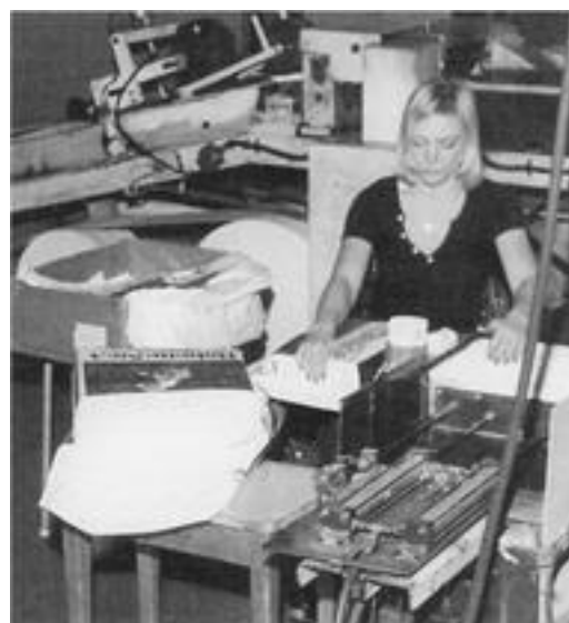
Maskiner för blöjtillverkning fanns inte på marknaden på 1960-talet. I Pauliström utvecklade och byggde man därför själva sådana och blev med tiden en ledande tillverkare av blöjmaskiner.
