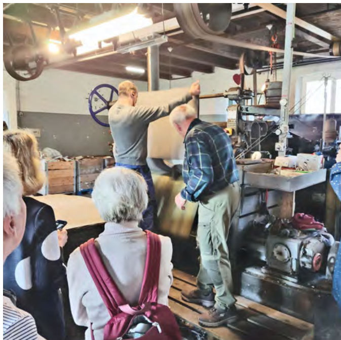
Pappen leveres som ark og tørkes hengende i en varmluftsovn.
