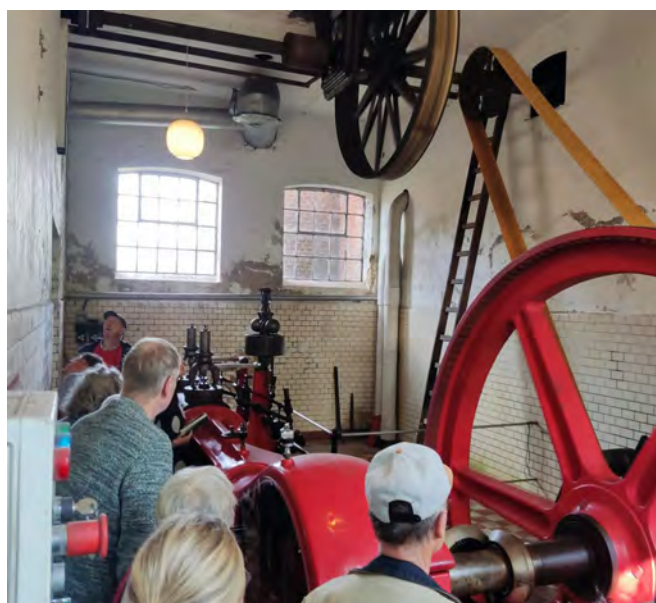
Maskinene på Brunshåb Gamle Papfabrik drives av en vakker dampmaskin.
