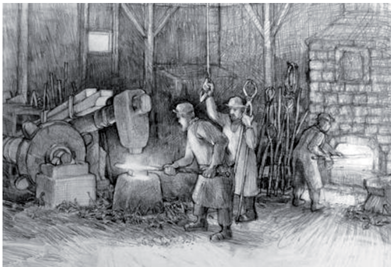
Denna teckning av Kjell Sundberg är en tänkt rekonstruktion av stångjärnshammaren vid Älvbron i Kristinehamn. Järnet upphettades i en ugn och bearbetades sedan av den tunga hammaren som lyftes av knaggarna på den roterande axeln. Hammaren föll sedan av sin egen vikt mot järnet och städet. Axeln drevs av ett vattenhjul. (Med tillstånd av konstnären)
