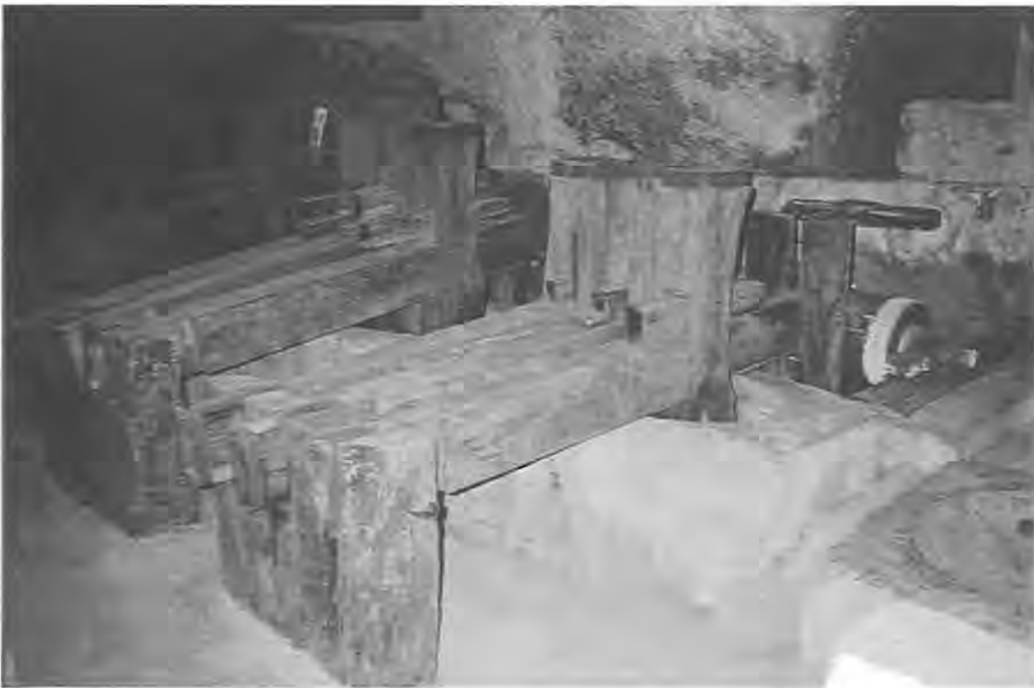
Det massiva stampverket av kastanjetråd kan fortfarande fungera. Amalfis pappersbruk drevs med vattenkraft genom ett sofistikerat kanalsystem som sträckte sig genom "kvarndalens" klippväggar. Foto: Angelo Tajani
