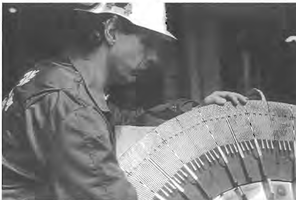
Iver Engebretsen på Follum Fabrikker hilste oss velkomne og tok oss på en rundtur. Her viser han en skiva som anvendes i den termomekaniske flishantering.
