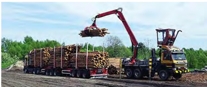
Lastning av massaved på en 74 tons lastbil.
