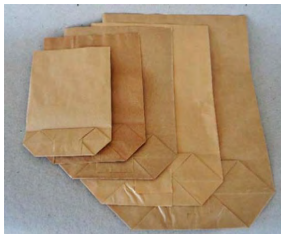
Kanisterpåsar med sexkantig botten. Kanister kommer från tyskan och betyder på svenska en liten (bleckplåts-) dosa. Bottenvikningen vid påstillverkningen sker utan någon förlust av material och i detta fall har en extra förstärkningslapp klistrats över botten skarvarna.
