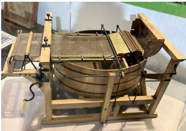
Denna modell av Robert's maskin finns på Frogmore Paper Mill i England för att illustrera grunden för deras egen första pappersmaskin.
